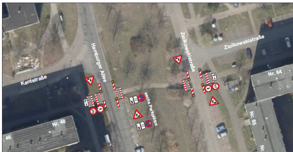
Blick auf die Gehweginstandsetzungen im Bereich Hamburger Allee und Ziolkowskistrasse
